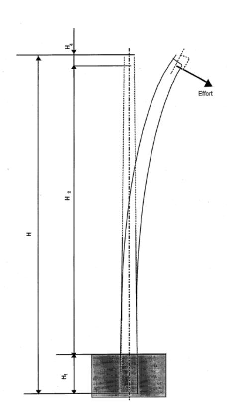
Annexe. 4 : Schéma de l'essai de Torsion
